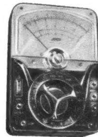
**OTRA 180** 0,6/6/30/120/600/1200/6000 V = 6/30/120/600/1200/6000 V  $\sim 20\ 000\ \Omega/V$  = und 10 000  $\Omega/V \sim 0,06/6/60/600$  mA, 12 A = 5 k/500 k/5 Mg/50 Mg  $\Omega$  — 20  $\sim$  + 63 dB; mit eingebautem Kond. für Outputmessung
