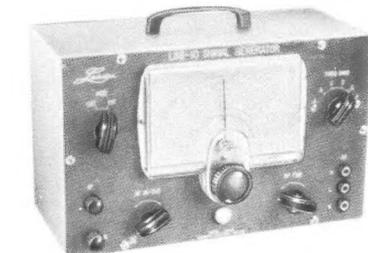
**Prüfsender LSG 10** 120 kHz bis 260 MHz, 6 Bereiche, Eigen- und Fremdmodulation. Ausgangsspannung kontin. regelbar. Frequenzgenauigkeit 2%. Röhren 12 BH 7 und 6 AR 5. Maße: 155 x 250 x 130 mm **DM 188.—**
